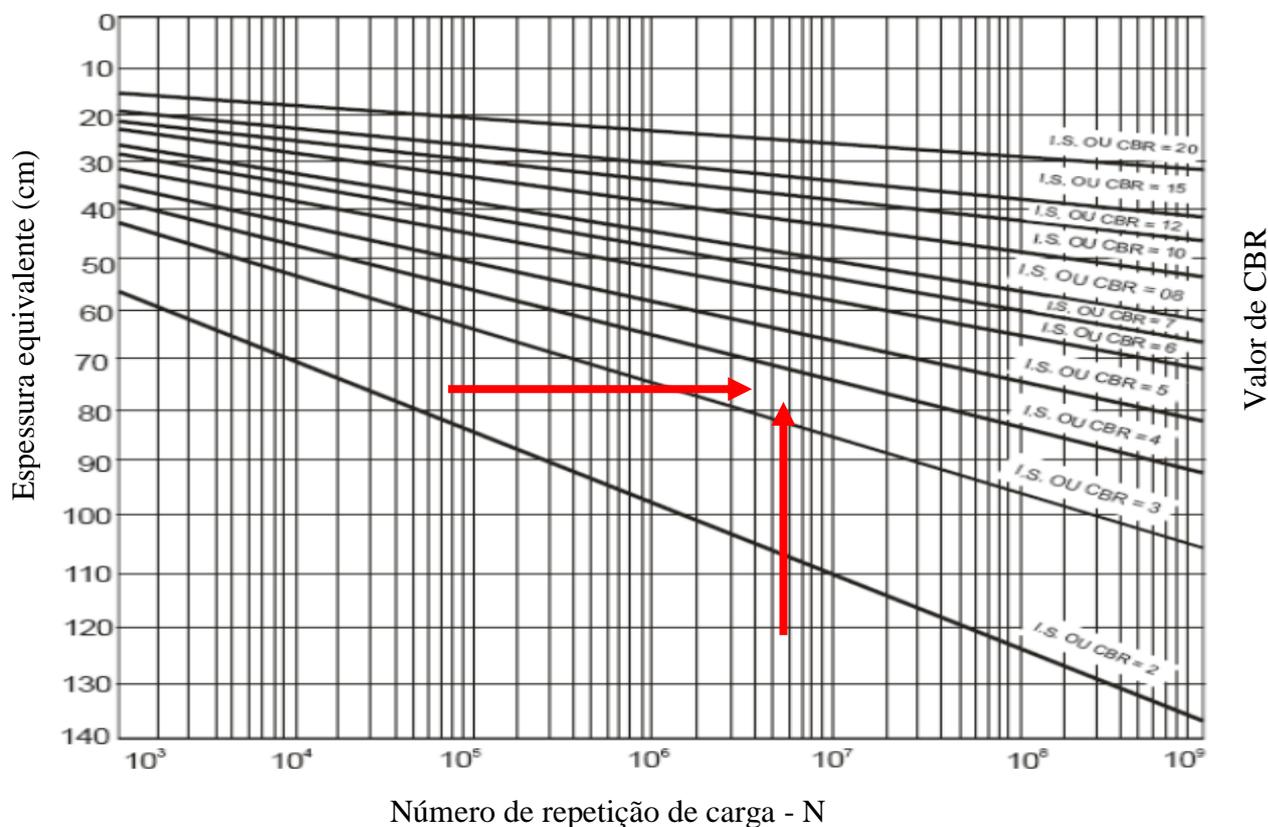
Determinadas às espessuras  $H_m$ ,  $H_n$ ,  $H_{20}$  pelo gráfico característico do método, e  $R$  pela tabela das espessuras mínimas da base (B), sub-base ( $h_{20}$ ) e reforço do subleito ( $h_n$ ), são obtidas pela resolução sucessiva das seguintes inequações:
