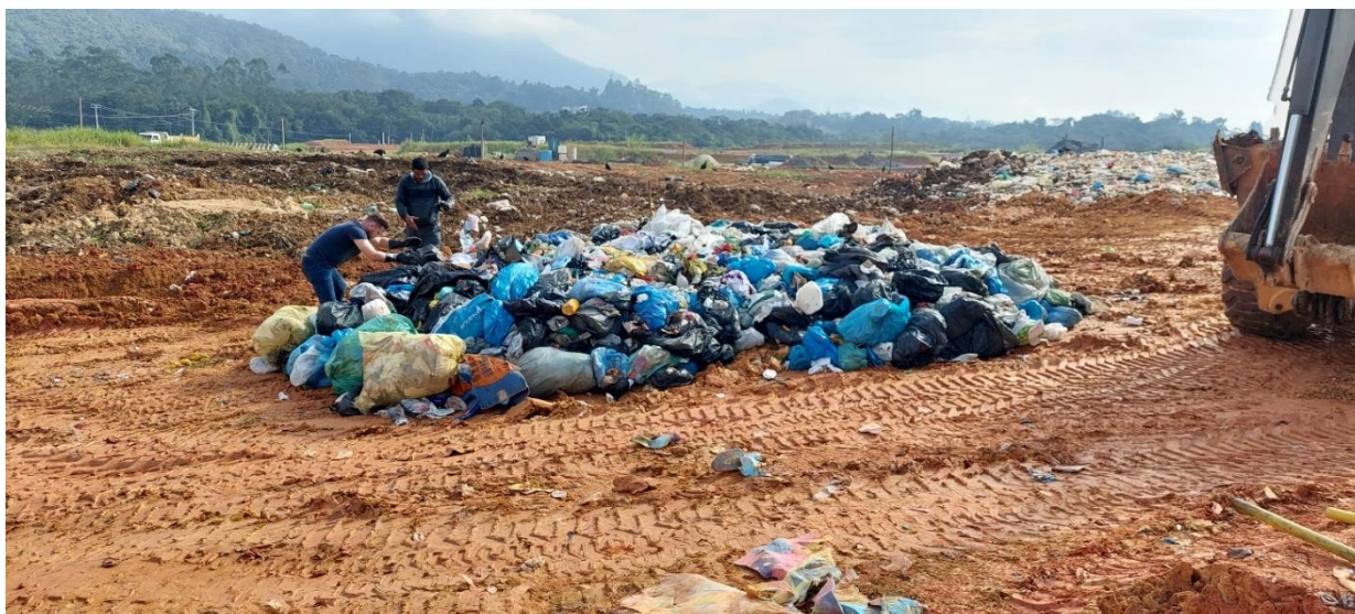
Figura 10 – Início do quarteamento dos resíduos – Coleta convencional – Rodeio
